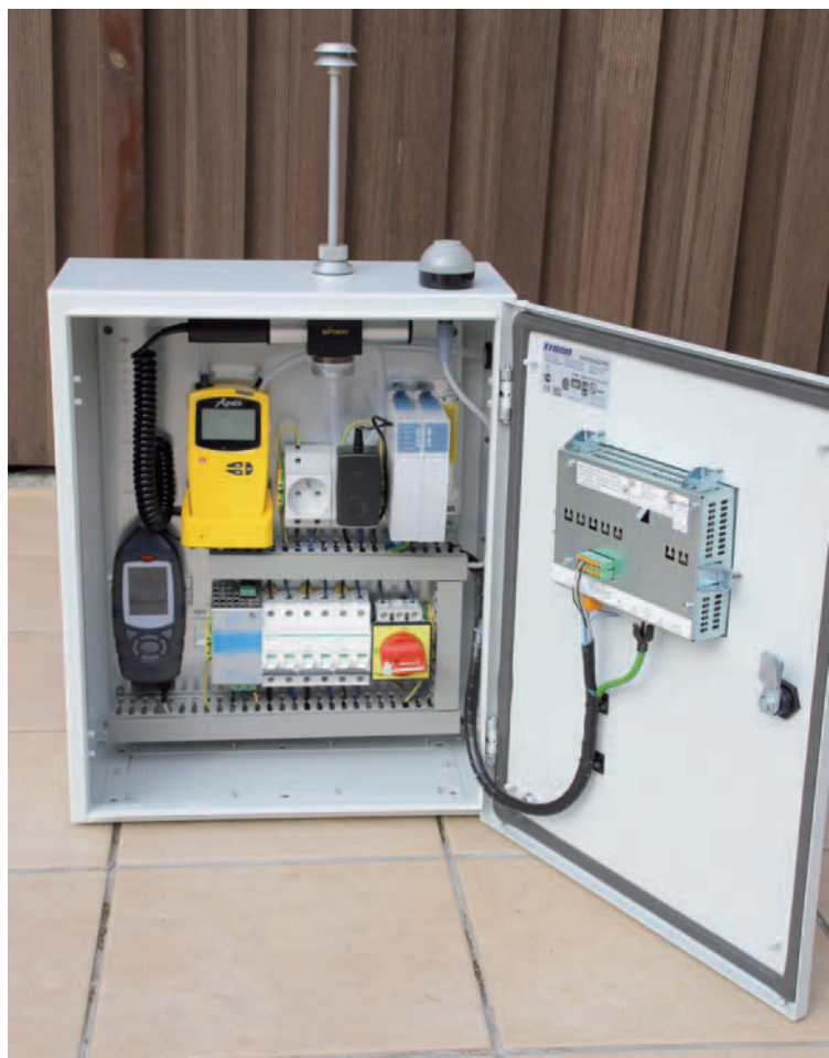
In samenwerking met AAsys en Sigmacontrol heeft Optyl binnen twee weken een kast voor een stofmeter geëngineerd en geprogrammeerd met alarmering, visualisering en CPU-verwerking met één standaard kaart.
